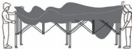
4. Uchopte středové T-spojky, čili horní a dolní černé plastové spojky ve středu rámu a couvejte směrem od sebe až rám střechy plně vypněte. Zároveň zkontrolujte že ve všech čtyřech homických rohových L-spojkách zaklaply pojistné koliky. Případně je dodatečně tlakem na rámovou vzpěru zavakněte.
