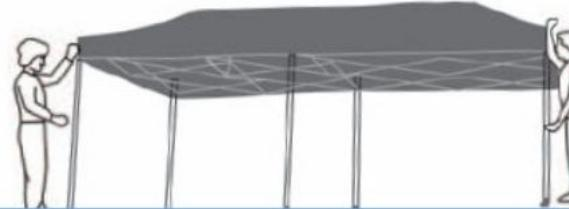
6. Výšku jednotlivých stojek nastavte tak, že zvolíte jeden z polohovacích otvorů. Výšku stavěte vždy na stejné straně proti sobě, stlačením páčky aretačních spojek. Zvolený výškový otvor by měl být pro všechny stojky stejný, ledaže stavíte stan ve svahu nebo na jiné nerovnosti. Na zvoleném otvoru uvolněte páčku aretační spojky, čímž dojde k zacvaknutí aretačního kolika.
